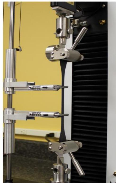
▲ El Extensómetro permite al aparato Vantage de Thwing-Albert ensayar materiales de alta elasticidad
