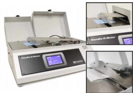
El Handle-O-Meter mide el efecto combinado de la flexibilidad y de la fricción superficial de materiales laminados
