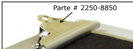
Mordaza para mantener la muestra en posición
