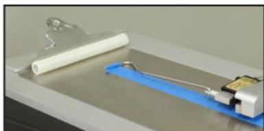
La barra para ensayos de despegado a 180° está incluida en todos los aparatos FP-2260 .
